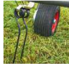
I denti "Super C" di 9,5 mm sono in acciaio ad elevata resistenza e si caratterizzano per la lunga durata e i risultati eccezionali.
